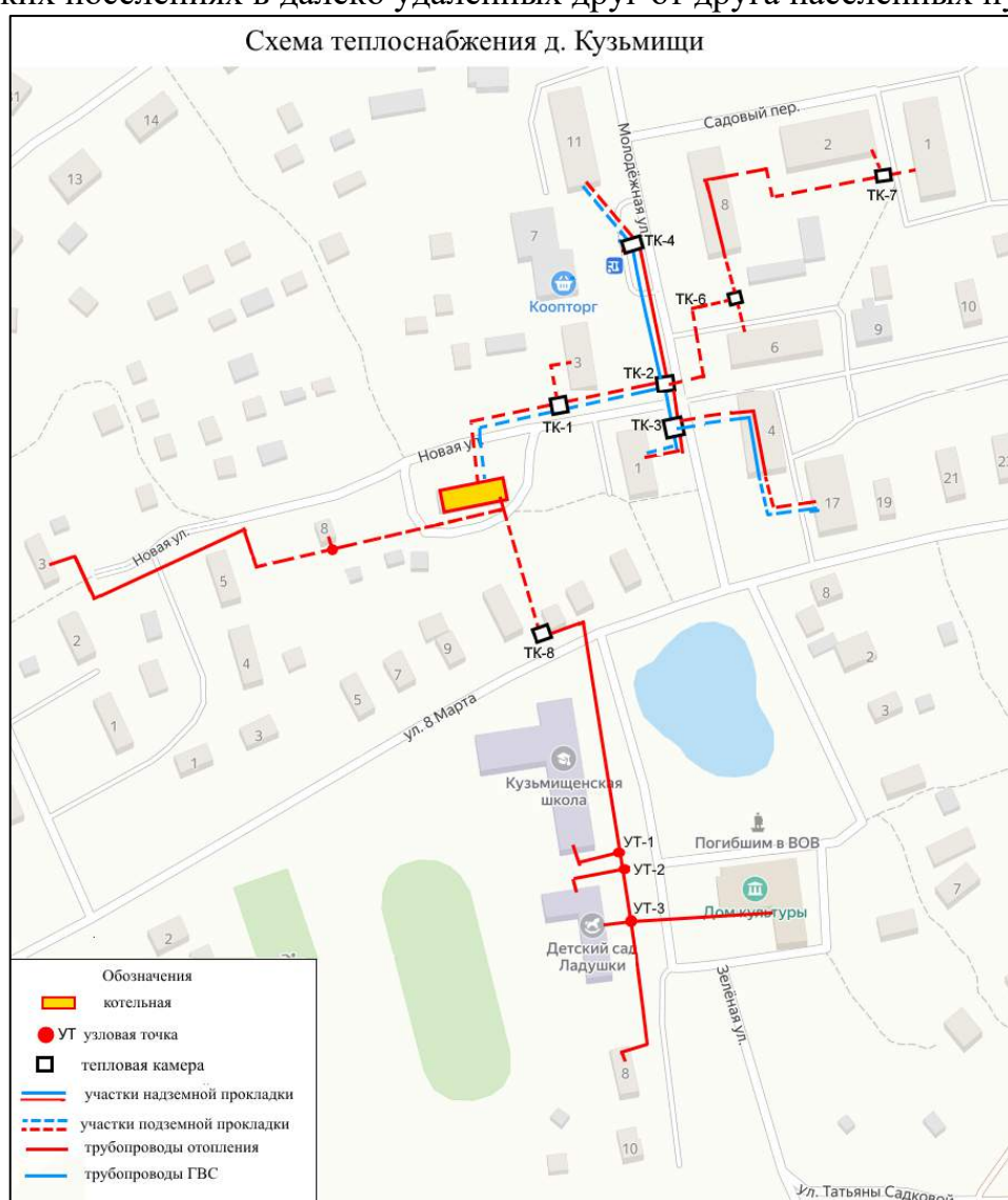
Рисунок 1.4.1 – Схема тепловых сетей д. Кузьмищи
